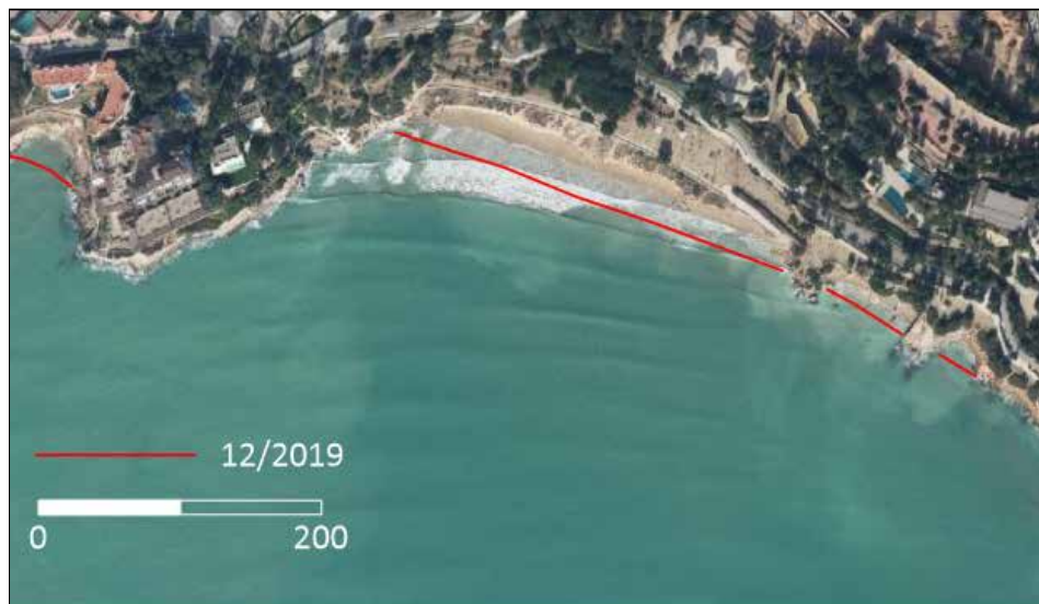
FIGURA 8. Configuració de la platja Llargueta i cala Llangadets a Salou després de l'impacte del Gloria . S'observa la pràctica desaparició de totes dues platges. La fotografia és del vol efectuat per l'Institut Cartogràfic i Geològic de Catalunya (ICGC) els dies 24 a 27 de gener de 2020. La línia vermella mostra la posició de la línia de riba abans del temporal i ha estat digitalitzada a partir de les imatges obtingudes en els vols realitzats per l'ICGC. Escala gràfica en metres.
