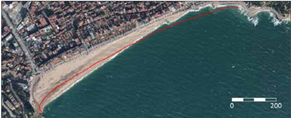
FIGURA 12. Configuració de la platja de Lloret de Mar després de l'impacte del Gloria . S'observa el basculament de la línia de riba cap a ponent. La fotografia és del vol efectuat per l'Institut Cartogràfic i Geològic de Catalunya (ICGC) els dies 24 a 27 de gener de 2020. La línia vermella mostra la posició de la línia de riba abans del temporal, el desembre de 2019, i ha estat digitalitzada a partir de les imatges obtingudes en el vol realitzat per l'ICGC en aquella data. Escala gràfica en metres.
